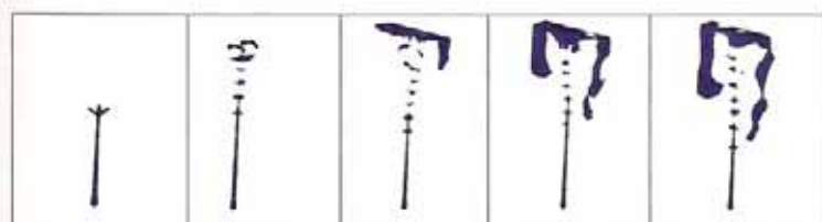
Рис. 5. Влияние на форму струи противодействия газа при различных скоростях на входе в питатель: а - \theta_{пит} = 30 м/с; б - \theta_{пит} = 5 м/с
