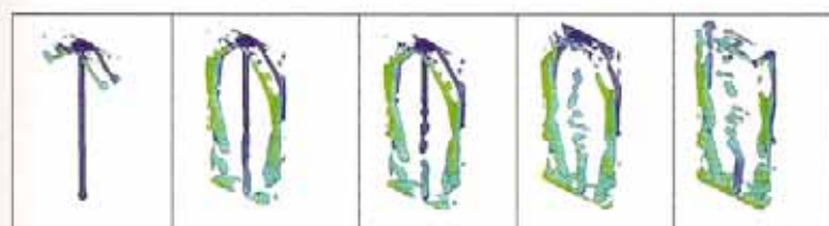
Рис. 4. Результаты моделирования формы струи при переменной скорости на входе в питатель и поверхностном натяжении: а - \theta_{пит} = 5 м/с; б - \theta_{пит} = 10 м/с; в - \theta_{пит} = 5 м/с и \sigma = 0,85 Дж/м 2
