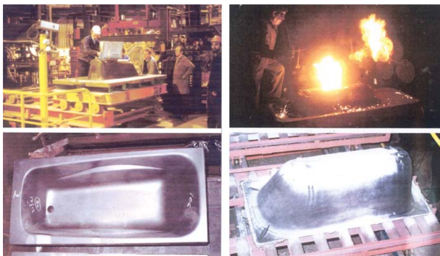
Рис.9. Линия литья ванн по V-процессу во Франции на заводе Porcher (1985 г.)
