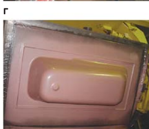
Рис.3. Рабочие операции формовочной линии Кировского завода: а – подача модели низа на поворотной карусели; б – наложение нагретой пленки на модель; в – захват и съем вакуумной полуформы низа с «болваном»; г – транспортировка форм; д – готовая полуформа низа перед сборкой; е – предварительный поворот полуформы низа для осмотра
