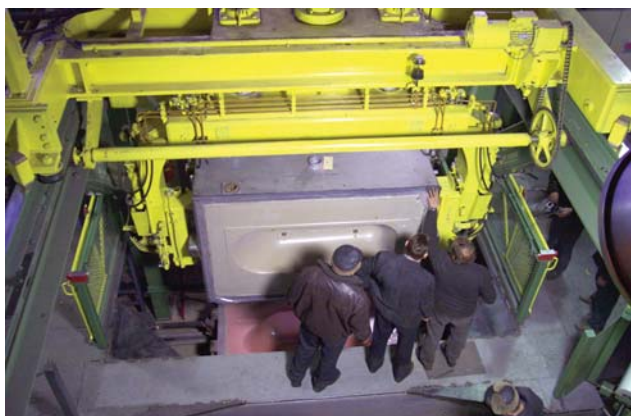
Рис. 10. Позиция осмотра полуформ верха до сборки для оценки качества на линии по V–процессу
