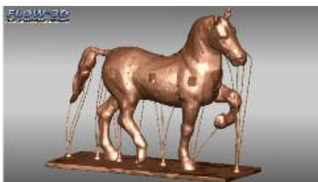
Immagine in falsi colori della fusione. I colori utilizzati sono quelli del bronzo, con sfumature più scure nelle zone in cui il software ha rilevato una maggiore quantità di difettosità.
