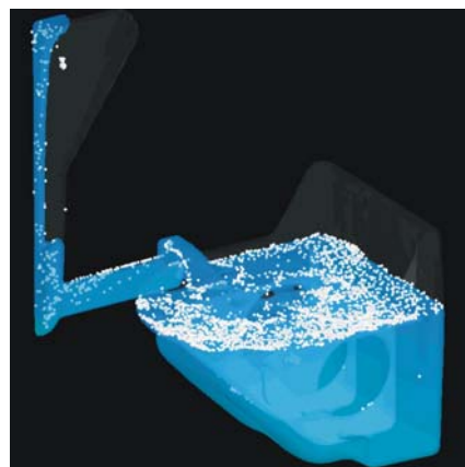
Рис. 7. Распределение частиц ферросилиция в расплаве на промежуточном этапе заливки
